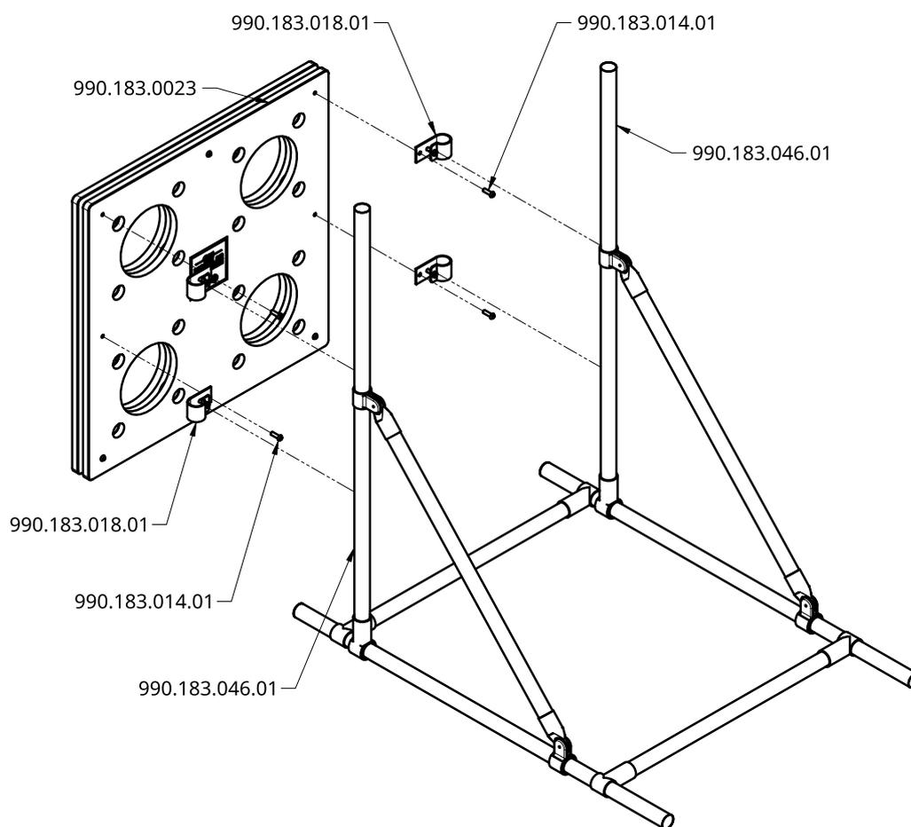
Bei der Lagerung von kürzeren Rollen das Modul weiter vorne platzieren, um der Kippgefahr entgegenzuwirken!
